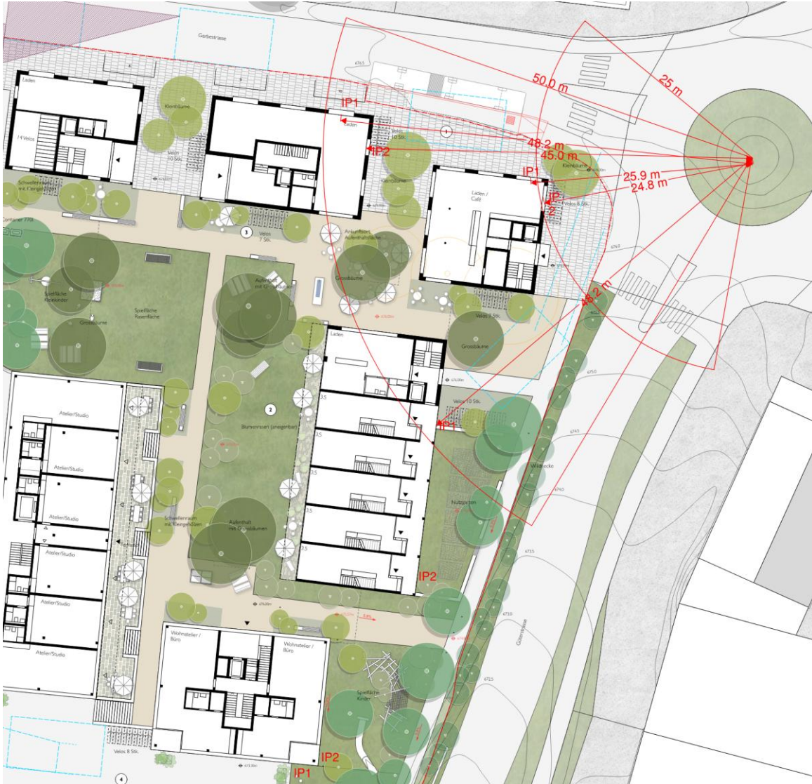
Abb.: Situationsplan mit Distanzmessung zu Mittelpunkt Kreisel
